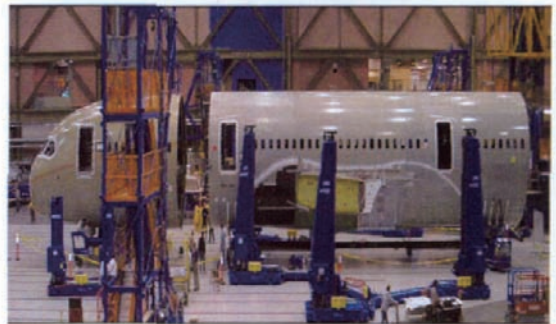
图2 波音787的机身段自动对接系统 Fig.2 Automatic butt system of Boeing 787
